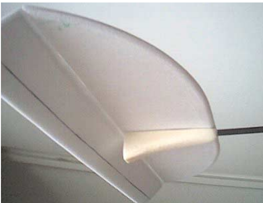
Photo 16 Notez le ponçage pour arrondir le BA du stab. Ne tenez pas compte du trait noir sur la profondeur.
