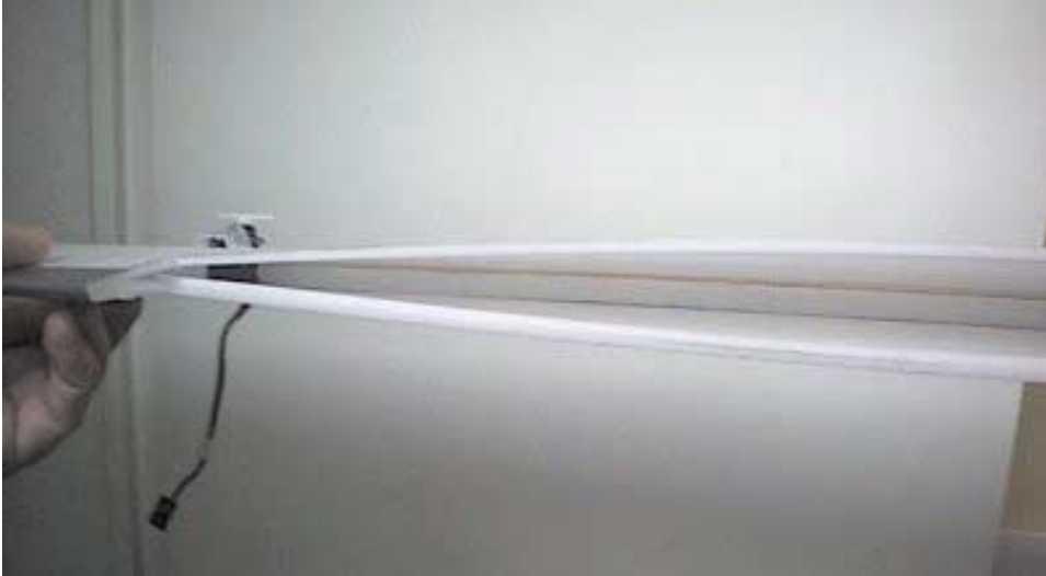
Photo 10 Quand on découpe les ailerons l'aile se déforme comme ceci. On va remédier à ça.
