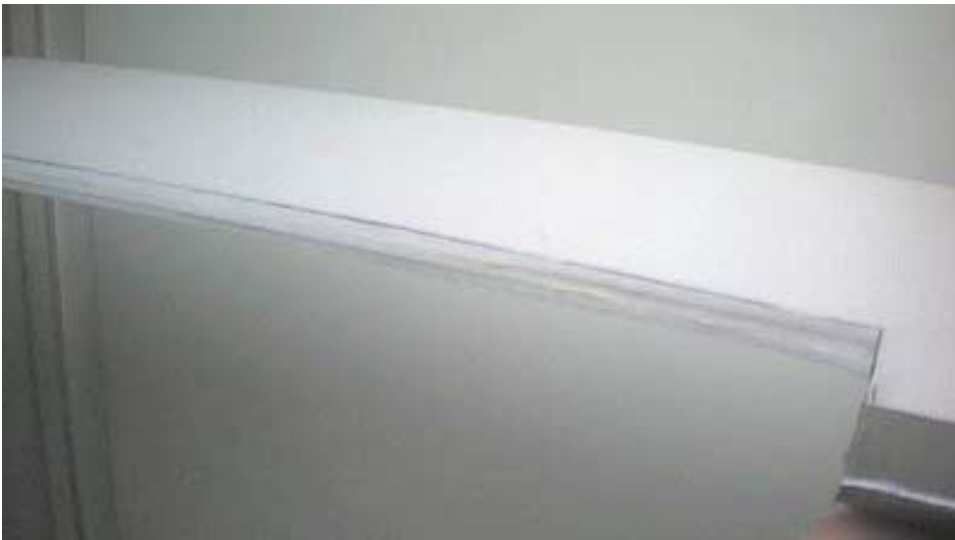
Photo 11 On va coller une découpe de dépron de 3 x 3 mm tout le long entre l'intrados et l'extrados en veillant à ne pas vriller l'aile.
