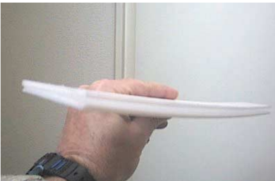
Photo 12 Vous pouvez coller ces deux épaisseur à l'Aracol ou encore mieux car plus légère, à la néoprène SANS solvant. Dans ce cas précis le collage à la néoprène s'y prête bien.
