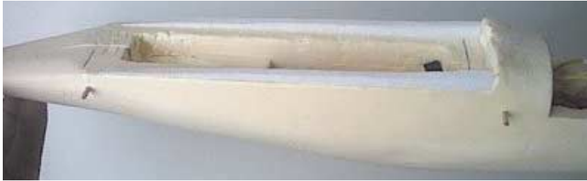
Photo 14 Transpercez le fuselage bien perpendiculairement à celui ci.
