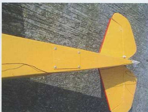
Pour respecter le centrage sans ajout de lest, l'auteur a installé la batterie de réception à l'arrière de l'avion sous cette trappe.
