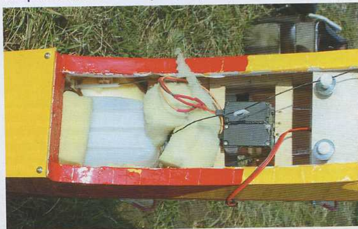
Gros plan sur l'installation radio qui se partage l'espace avec le réservoir.
