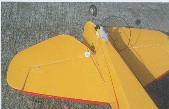
Les tringleries de profondeur et de direction sont reliées aux guignols via des connecteurs à vis.
