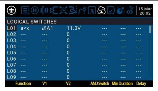
Le réglage de l'exemple L01 sur la figure est exprimé comme suit: Lorsque la valeur de retour A1 est inférieure à 11,0 V, le commutateur L01 est automatiquement activé. Dans les paramètres des autres pages, L01 a la même fonction que le commutateur physique. Vous pouvez activer ou désactiver la fonction correspondante pour L01. De cette façon, un interrupteur est automatiquement exécuté en fonction des paramètres qui changent en temps réel.
