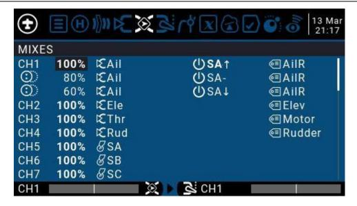
Pour modifier un contrôle de mixage, utilisez la molette de défilement pour sélectionner l'élément de contrôle de mixage vers le haut et vers le bas, et maintenez la touche ENT enfoncée pour accéder au sous-menu d'édition. Sélectionnez Modifier et appuyez brièvement sur la touche ENT.
