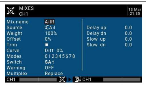
Nom du mélan: Réglage du nom Utilisez la molette de défilement pour sélectionner les lettres et les chiffres, et maintenez la touche ENT enfoncée pour basculer entre les majuscules et les minuscules. Appuyez brièvement sur la touche ENT pour définir le caractère suivant.
