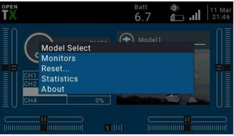
Sélectionnez Model Select pour accéder à la page de sélection de modèle, qui est utilisée pour créer, changer, supprimer et copier des modèles.
