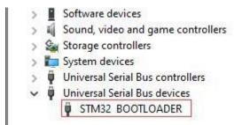
Avant d'écrire le firmware pour la première fois, vous devez remplacer le pilote STM32 BOOTLOADER pour vous assurer que le logiciel OpenTX Companion peut reconnaître ce type de matériel et écrire le firmware correctement. La méthode de remplacement est la suivante:
